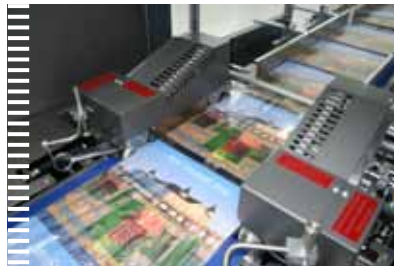
Servo Packer 500. Der schnelle Hybrid vereint Vorzüge einer universellen Seitenschweißmaschine und einer Folienverpackungsanlage, die extrem enges Verpacken ermöglicht.
