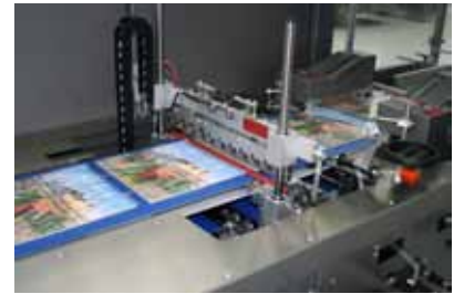
Servo Packer 500. Der schnelle Hybrid vereint Vorzüge einer universellen Seitenschweißmaschine und einer Folienverpackungsanlage, die extrem enges Verpacken ermöglicht.
