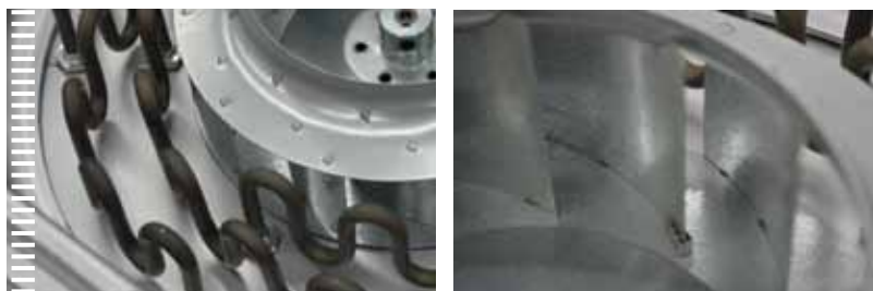
Le système de chauffe par turbines assure une transmission régulière de la chaleur sur le produit.
